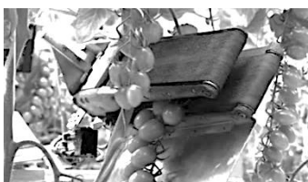
図1 画像データを用いた AI ロボットによるトマトの自動収穫
